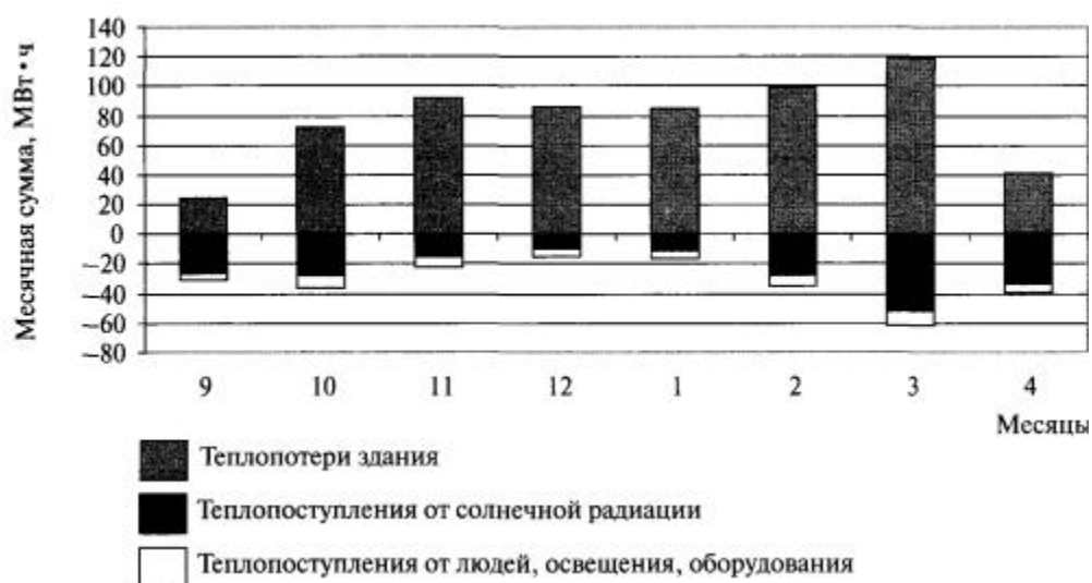
Рис. 39. Сравнение месячных сумм теплопоступлений и теплопотерь за время солнечного сияния в 9-этажном здании квадратной формы, построенном по старым нормам
